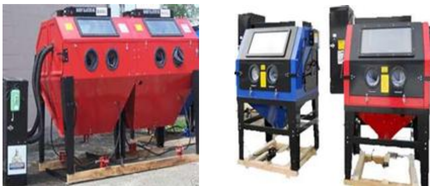
تصویر شماره ۲۰: انواع کابینت سندبلاست دستکشدار
